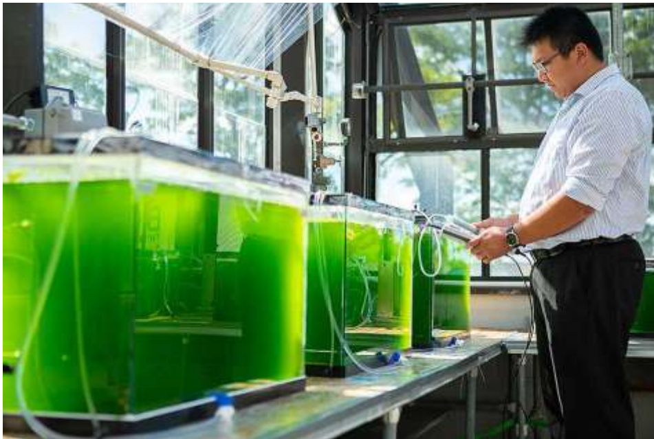
Slika 61. Bioreaktori u zatvorenim prostorima
