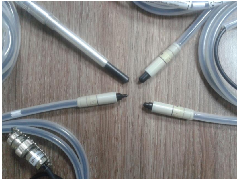
Slika 4.2. Primer cilindričnih jonizacionih komora različite zapremine šupljine
