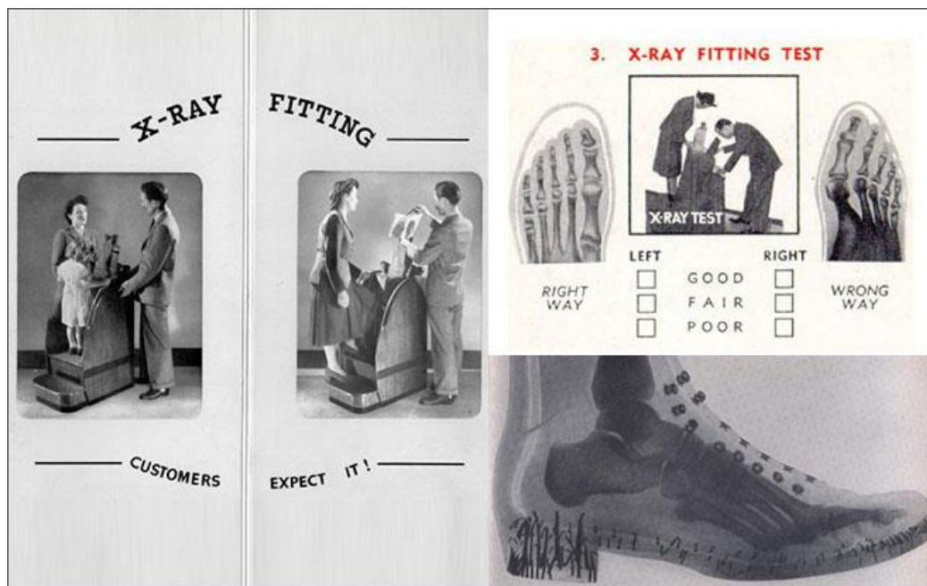
Slika 2.3. Pedoskop - rendgen aparat za probanje cipela
