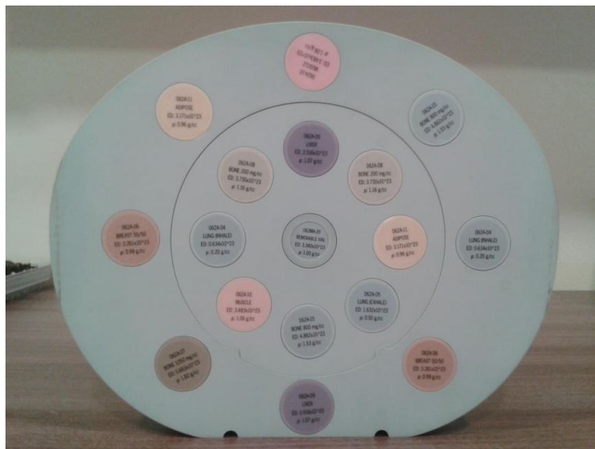
Slika 6.8. Fantom za određivanje konverzije krive CT broja u relativnu elektronsku gustinu
