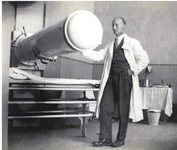
Slika 5.1. Rendgen uređaj firme Siemens, proizvodio je snop od 250 kV, a koristio se 20-ih godina 20. veka. Historad grupa, Netherlands Cancer Institute , Amsterdam, Holandija
