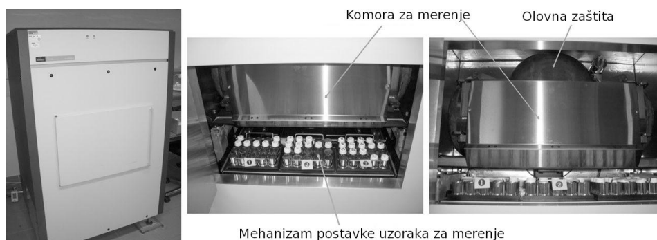
Slika 2.1. Izgled detektora Quantulus 1220 TM (slika levo), raspored uzoraka na tacnama unutar detektora (slika u sredini) i pasivna zaštita oko komore za merenje (slika desno) (Schubert et al., 2018).
