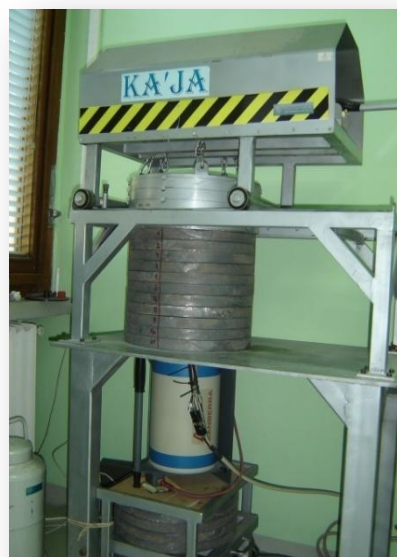
Slika 3.1. HPGe detektor u Laboratoriji za ispitivanje radioaktivnosti uzoraka i doze jonizujućeg i nejonizujućeg zračenja pri Katedri za nuklearnu fiziku na Prirodno-matematičkom fakultetu u Novom Sadu na kojem se mere uzorci vode u Marinelli geometriji.
