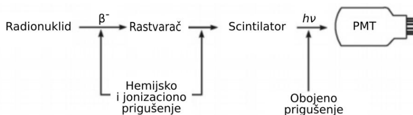
Slika 2.5. Šematski prikaz scintilacionog procesa uz prigušenje u LS brojaču (Todorović, Nikolov, Stojković, 2018).
