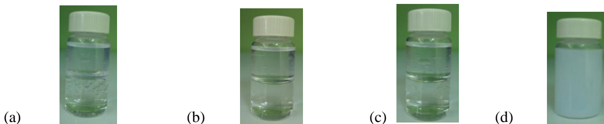
Slika 2.28. Uzorak vode pomešan sa organskim scintilacionim koktelom: (a) UltimaGold F (dvofazni uzorak), (b) Mineral Oil Scintillator (dvofazni uzorak), (c) OptiFluor O (dvofazni uzorak), (d) UltimaGold AB (monofazni/homogeni uzorak) (Nikolov et al., 2018b).
