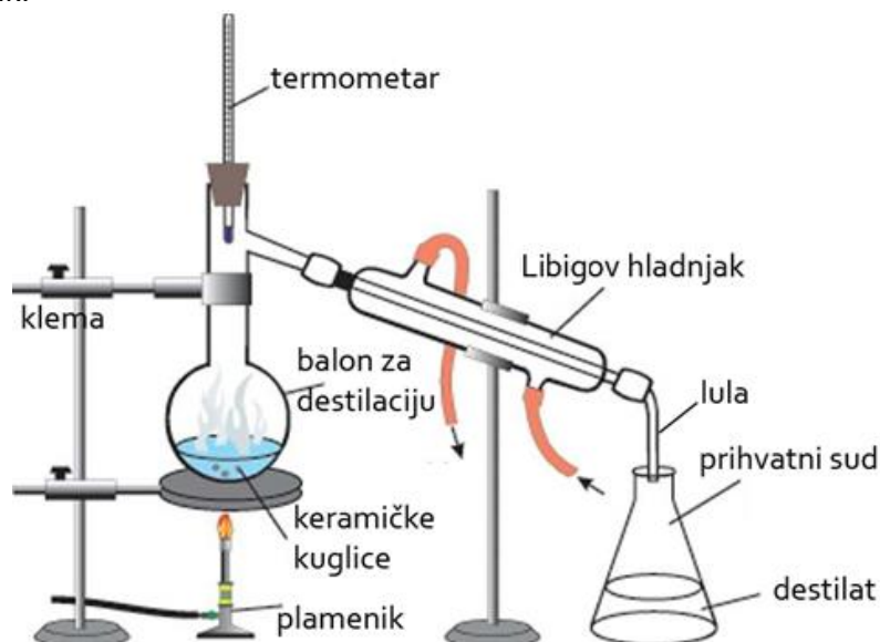
Slika 1.19. Aparatura za destilaciju pod atmosferskim pritiskom
