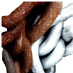
Slika 10.4. Uticaj kiseonika i vlage na oksidaciju gvožđa
