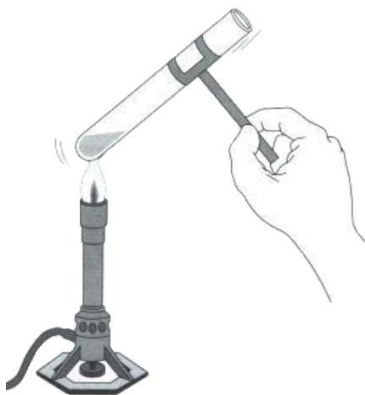
Slika 1.15. Zagrevanje tečnosti u epruveti na otvorenom plamenu Bunzenovog plamenika
