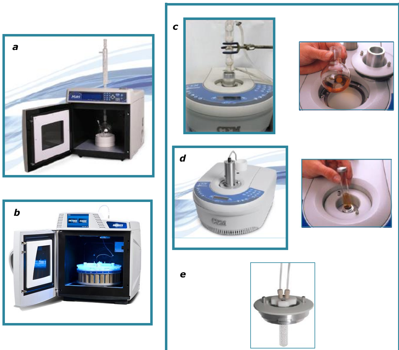
Slika 60. CEM-ovi modeli mikrotalasnih reaktora: Mars (multimodni) model adaptiran za rad pri atmosferskom (a) i povišenom pritisku (b); Discover (monomodni) model prilagođen za rad na atmosferskom (c) i povišenom pritisku (d); dodatak za kontinualno izvođenje reakcije (e)
