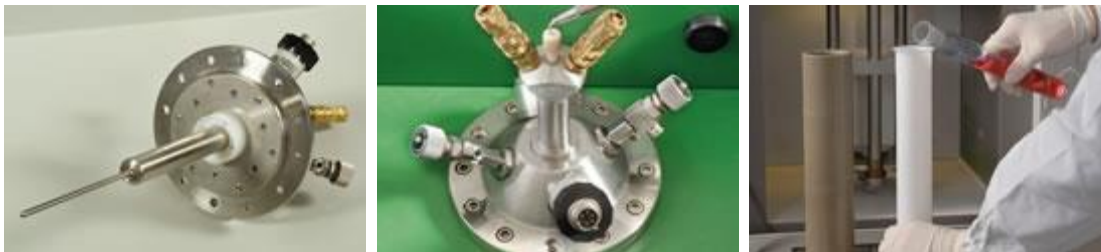
Slika 54. S leva na desno: BatchSYNTH merač temperature, dovodni i odvodni portovi i reakcioni sud od 300 mL
