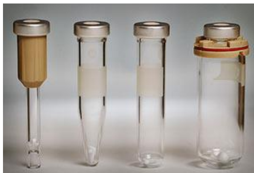
Slika 44. S leva na desno: reakcione viale od 0.2-0.5 mL (samo za EXP sistem), 0.5-2 mL, 2-5 mL, 10-20 mL (samo za EXP sistem)
