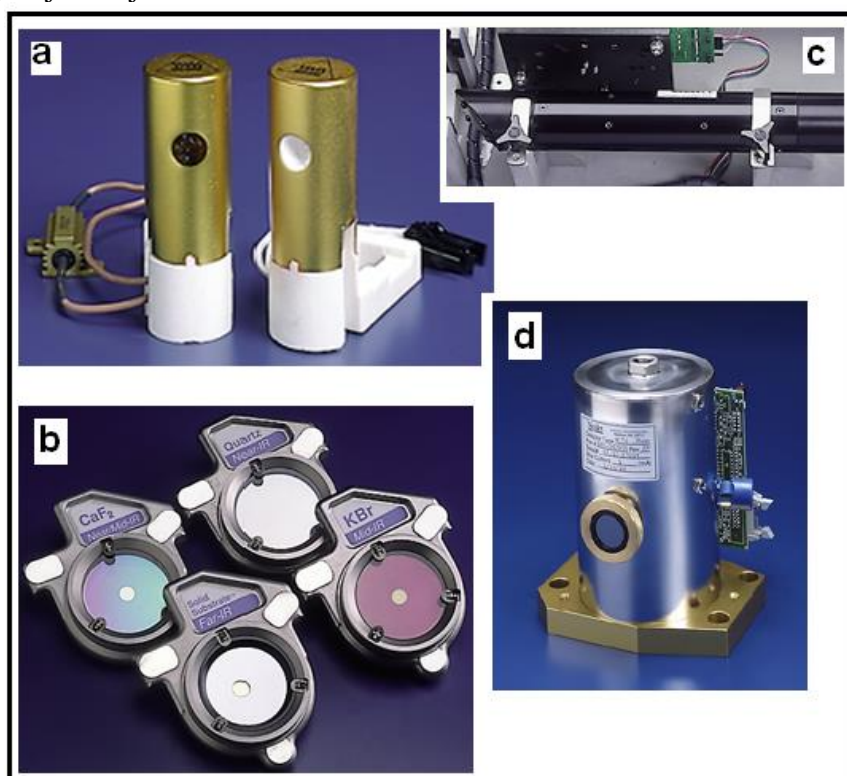
Slika 3.10 Izgled važnijih delova FTIR spektrometra a) izvor, b) delilac snopa zračenja, c) laser i d) detektor
