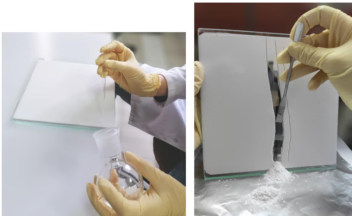
Slika 7. Nanošenje smese na preparativnu ploču (levo), skidanje zone adsorbenta sa supstancom nakon završenog razdvajanja (desno)
