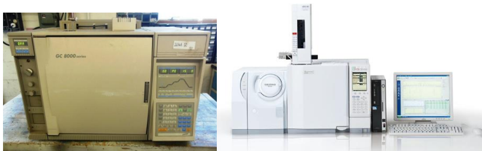
Slika 2.1. Izgled a) starijeg modela i b) savremenog GC–MS instrumenta
