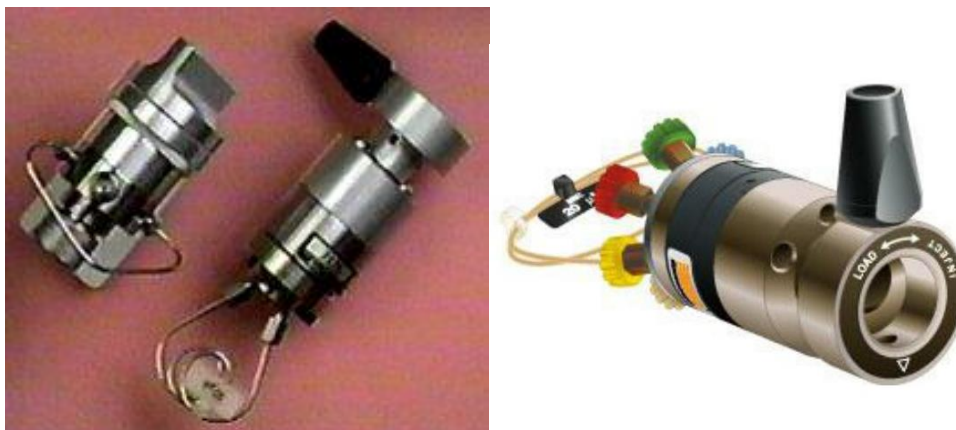
Slika 3.11. Tipični HPLC injektor. Nerđajući čelični prsten sa šest otvora od kojih je jedan povezan za kolonu
