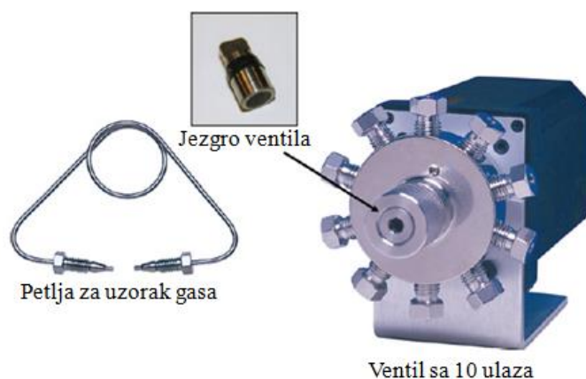
Slika 2.9. Ventil sa 10 ulaza i rotirajućim jezgrom (inset) i petlja
