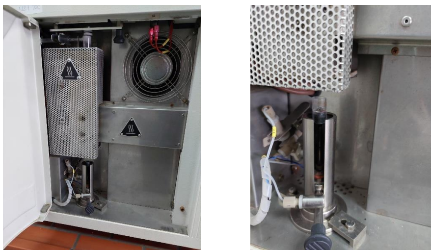
Slika 7.7. Segmenti TOC analizatora za analizu čvrstih uzoraka – prikaz reakcione peći i jedinice za postavljanje čamčića sa uzorkom
