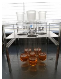
Slika 6.4. Reaktor za pripremu uzoraka digestijom za određivanje HPK vrednosti
