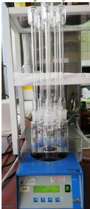
Slika 6.4. Reaktor za pripremu uzoraka digestijom za određivanje HPK vrednosti
